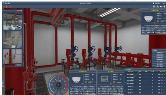
自动喷淋灭火系统软件模块
