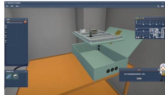
控制系统电气安装检测
