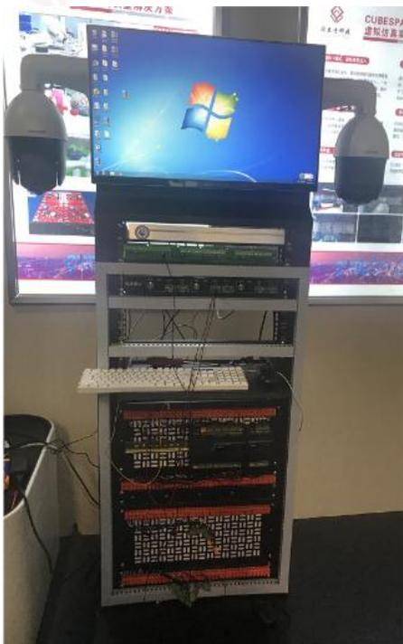
标准19寸机架设计，模块化安装
